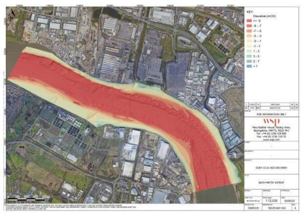
Figure 10: Bathymetric Survey (mCD)
